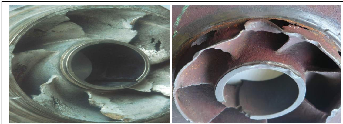
Figure V.4 : Photos illustrant le phénomène de cavitation sur des aubes d'une pompe centrifuge
