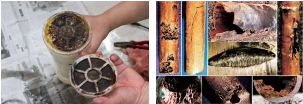
Figure I. 4. Effets du colmatage et de la corrosion sur les membranes de dessalement
