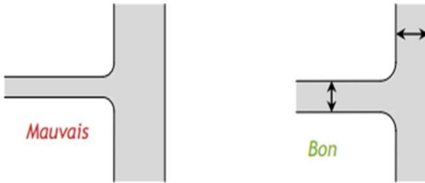
Fig. I-4 : Épaisseurs uniformes et non uniformes.
