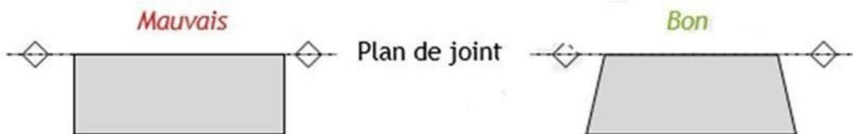
Fig. I-7 : Accumulation de matière et solution.
