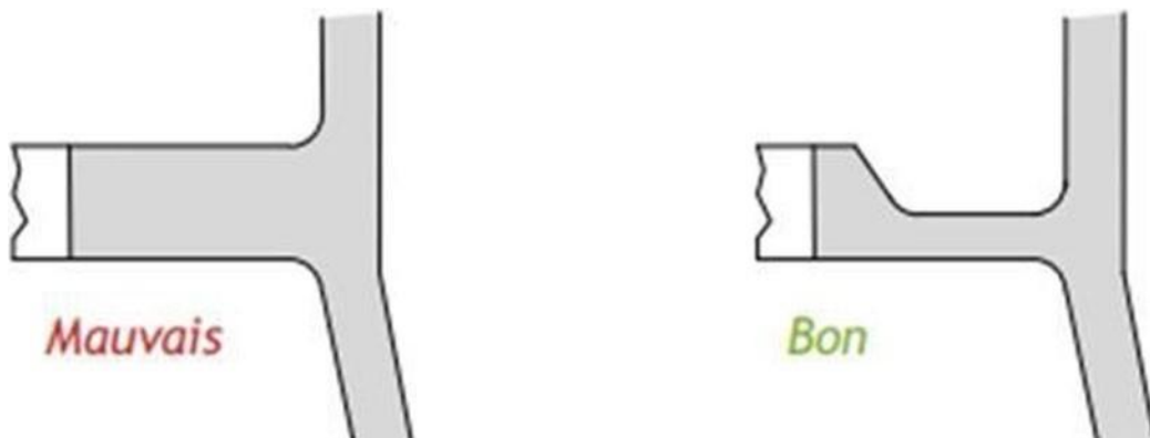
Fig. I-6 : Accumulation de matière et solution.
