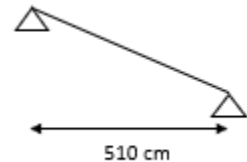
Figure 2-11: Schéma statique d'escalier entresol
