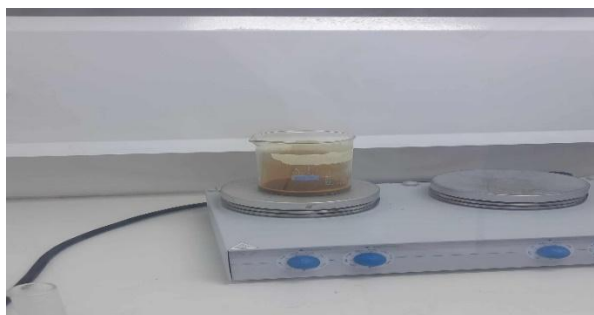
Figure II.10 : image du Chauffage de l' chantillon apr s ajout des acides.
