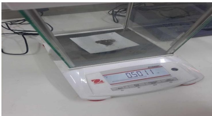
Figure II.8 : image de la Pes e d'un  chantillon de 0,5 g   l'aide d'une balance de pr cision.
