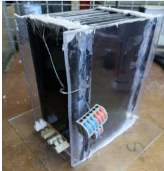
Figure IV.4 : Photo d'ensemble des deux étages d'ESP dans une enveloppe en plexiglas.
