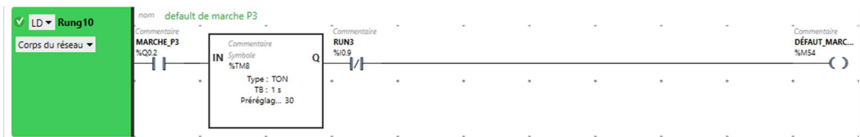
Figure (IV.10) : Réseau LADDER de détection du défaut de marche de la pompe P3.
