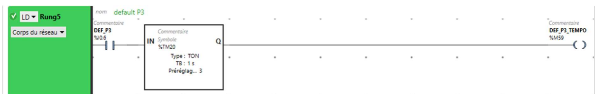
Figure (IV.6) : Réseau LADDER de détection de défaut de la pompe P3 avec temporisation (TON).
