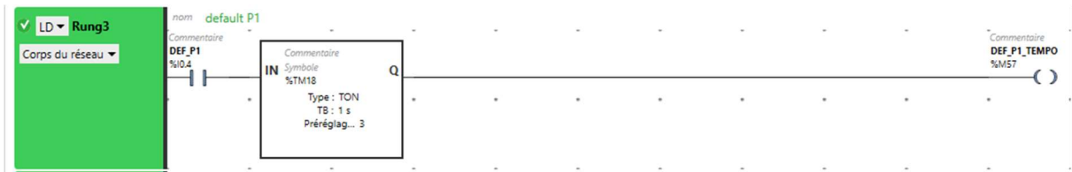
Figure (IV.4) : Réseau LADDER de détection de défaut de la pompe P1 avec temporisation (TON).
