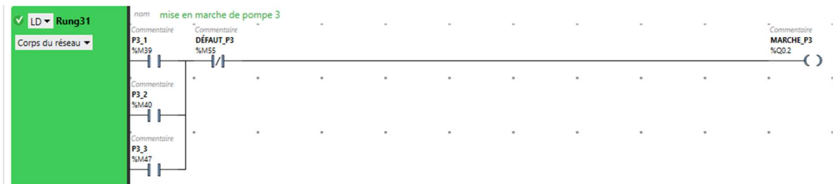
Figure (IV.17) : Réseau LADDER de mise en marche de la pompe P3.
