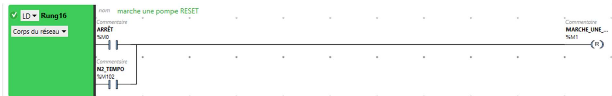
Figure (IV.16) : Réseau LADDER d'arrêt d'une seule pompe (fonction RESET).
