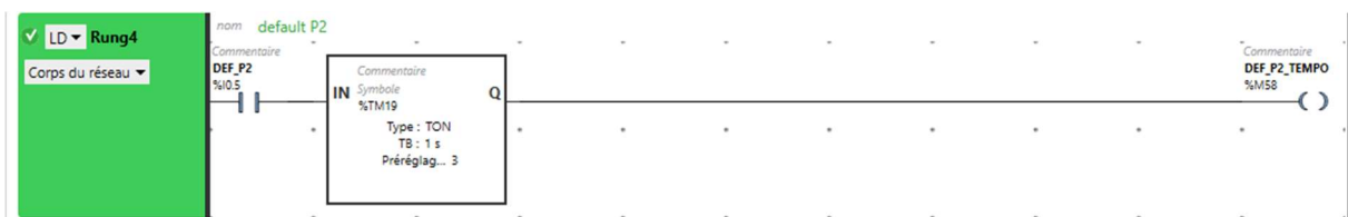
Figure (IV.5) : Réseau LADDER de détection de défaut de la pompe P2 avec temporisation (TON).
