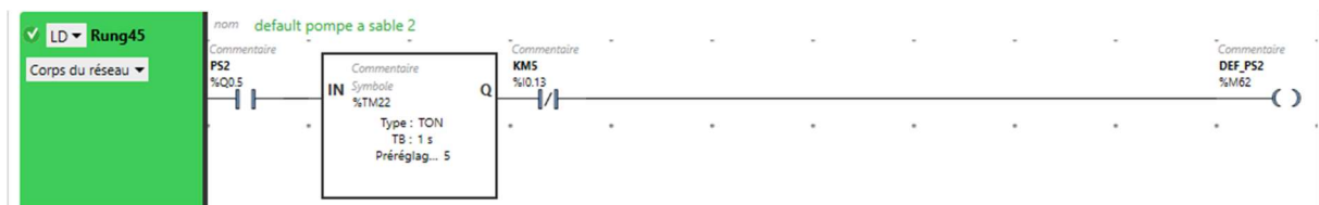
Figure (IV.24) : Réseau LADDER de détection de défaut de la pompe à sable 2.
