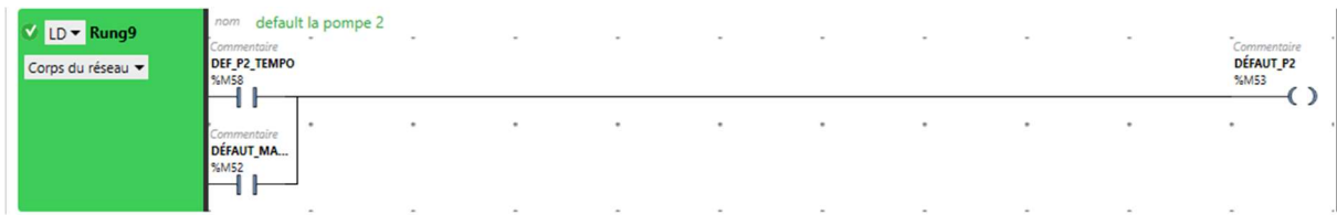
Figure (IV.9) : Réseau LADDER de validation du défaut de la pompe P2.
