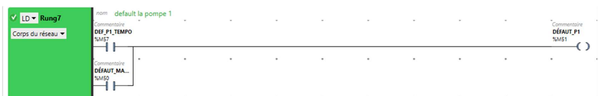
Figure (IV.7) : Réseau LADDER de validation du défaut de la pompe P1.
