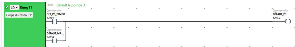
Figure (IV.11) : Réseau LADDER de validation du défaut de la pompe P3.
