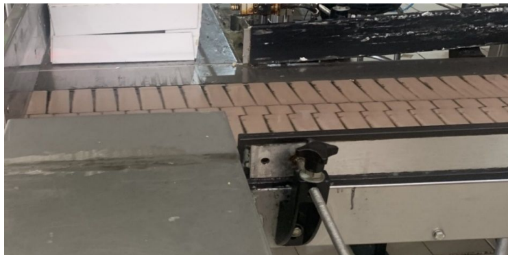
Figure I.2 : Convoyeur de type bande modulaire plastique droit.
