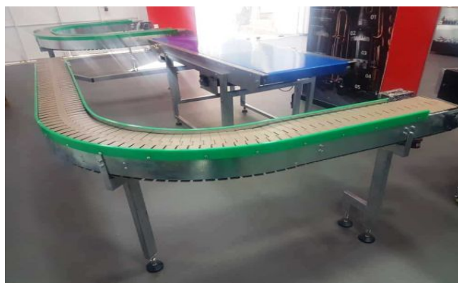
Figure I.3 : Convoyeur de type bande modulaire plastique courbe.
