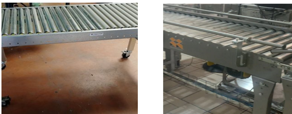
Figure I.4 : Convoyeur de type à rouleau libre/motorisé.
