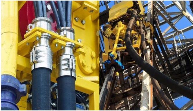
Figure III.8 : Interfaces Électrique et Hydraulique du Système Top Drive[2]
