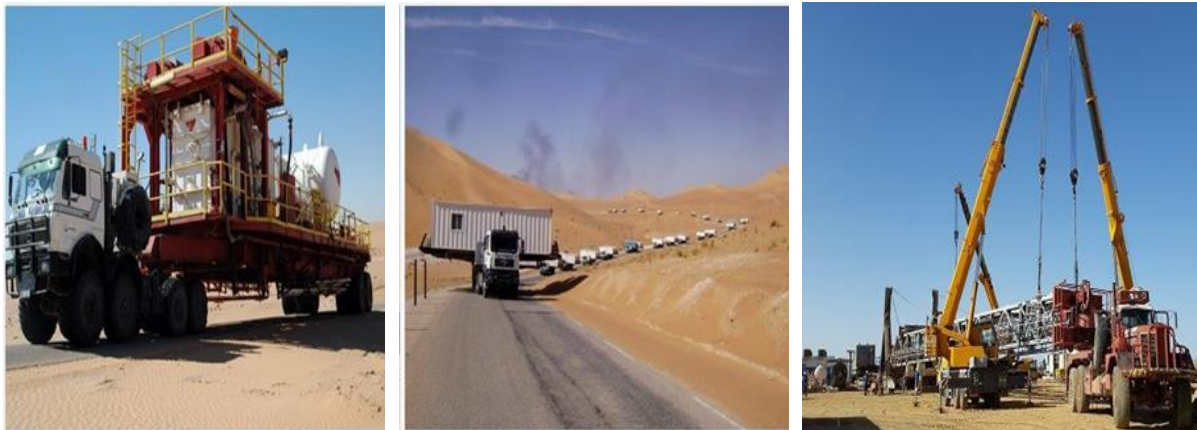
Figure I.2 : Démontage, Transport et Montage - Rig Move (DTM).
