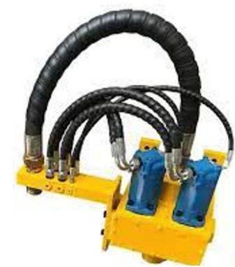
Figure III.8 : Interfaces Électrique et Hydraulique du Système Top Drive[2]
