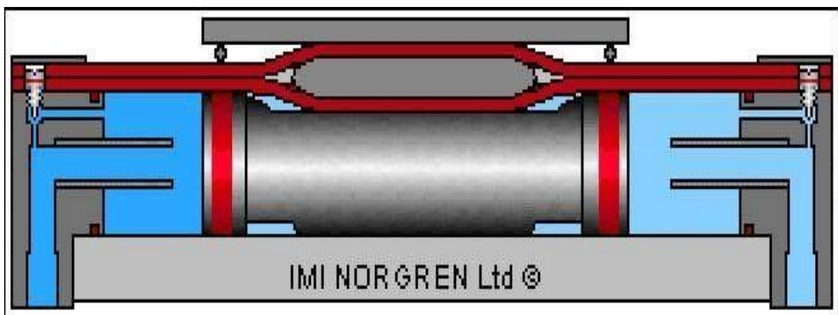
Figure I-1 : un vérin double effet sans tige avec amortissement des deux Côtés.[1]
