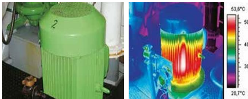
Figure 2.5 Image visible et image thermique d'un moteur électrique entraînant une pompe dans la salle des machines d'un bateau-citerne [13]
