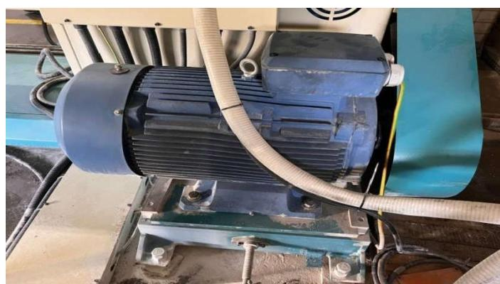
**Figure III- 4.** Moteur d'entraînement d'une extrudeuse mono vis MTP/EX-TP-75.
