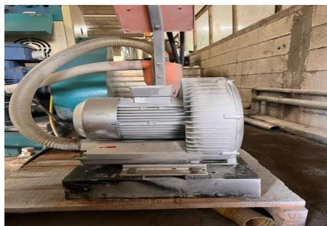
**Figure III-7.** Pompe à vide d'une extrudeuse mono vis MTP/EX-TP-75.
