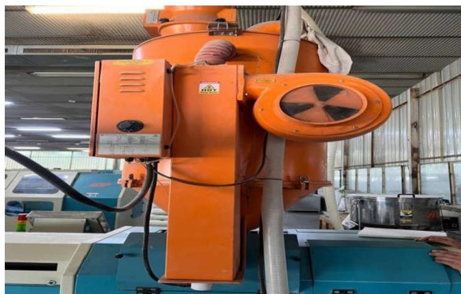
**Figure III-8.** Sécheur de PP de l'extrudeuse MTP/EX-TP-75
