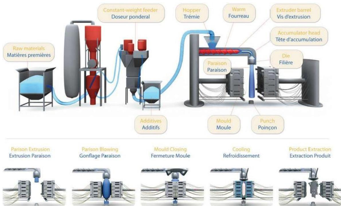
Figure I-4. Procédé d'extrusion soufflage
