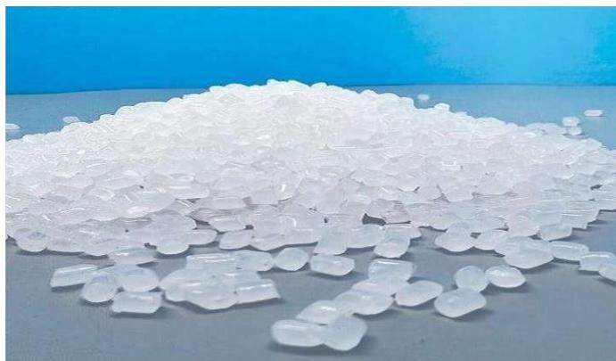
**Figure I-6.** Les granules de polypropylène
