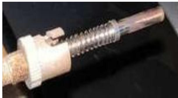
**Figure III- 1. Thermocouple d'une extrudeuse mono vis MTP/EX-TP-75**
