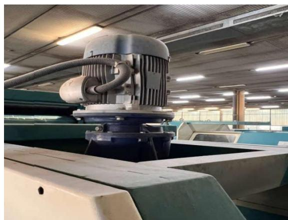
**Figure III- 5.** Le moteur de compression de l'extrudeuse mono vis (MTP/EX-TP-75).
