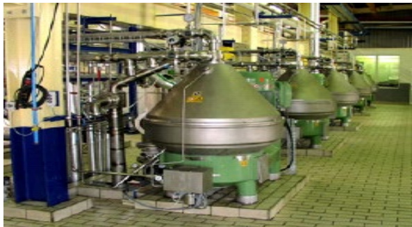
Figure I-1 : Séparateur où s'effectue le Dégommage.
