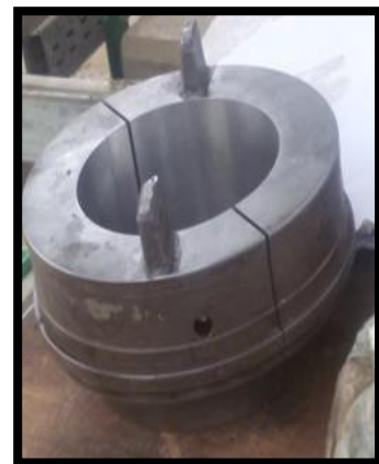
Figure 2.9 : bague d'étanchéité de butée
