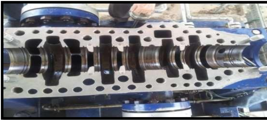
Figure 2.5 : Demi corps inférieur de la pompe
