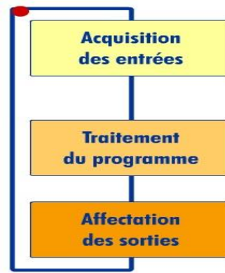
Figure II.1: Fonctionnement d'un API
