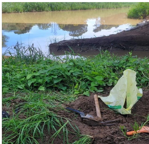
Figure 12 : prélèvement manuel des sédiments
