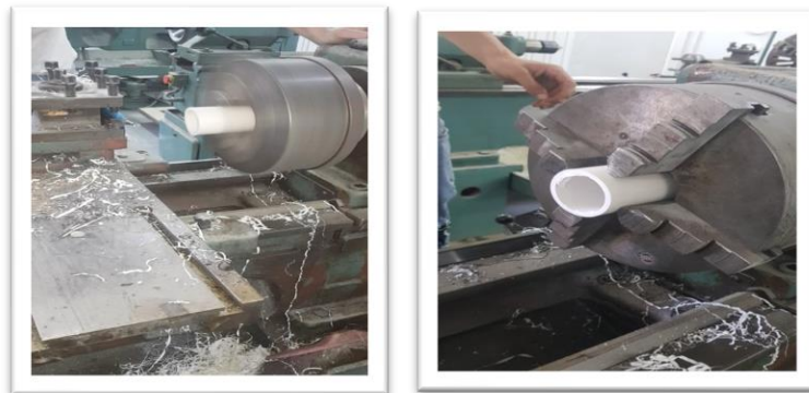
Figure 4.1 : découpage des moules à l'aide d'un tour mécanique.
