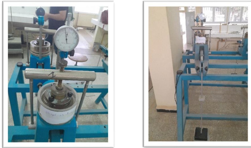
Figure 2.15: montage de la cellule et déroulement de l'essai œdométrique.
