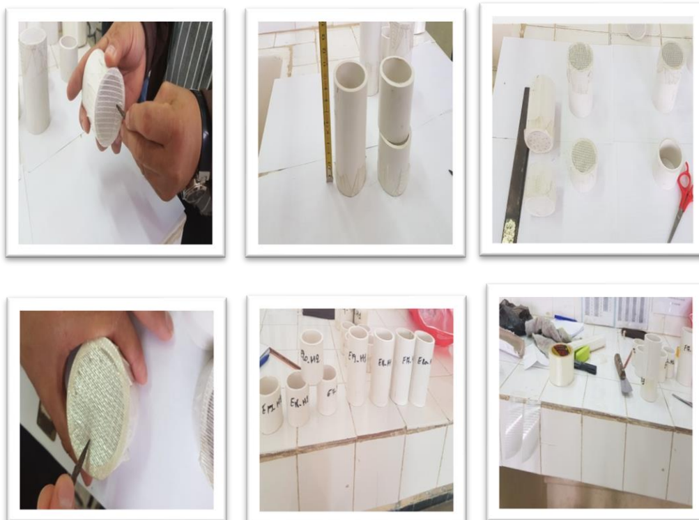
Figure 4.2 : étapes de préparation des moules.
