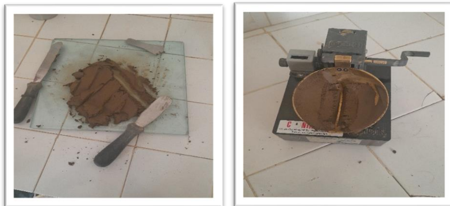
Figure 2.5: Déroulement d'essai Limites d'Atterberg.
