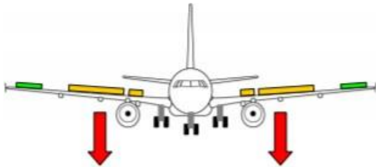
Figure II.15. Braquage des spoilers pour créer de la déportance lors Figure [18]
