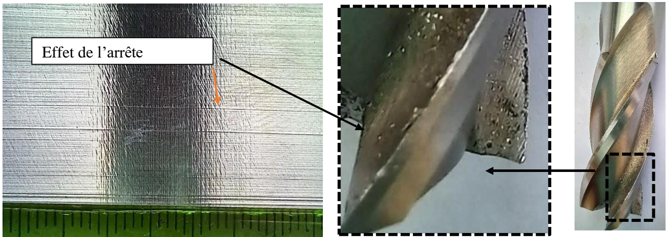
Figure (42) : Présentation de l'effet de l'arrête rapportée sur la surface de la pièce usinée
