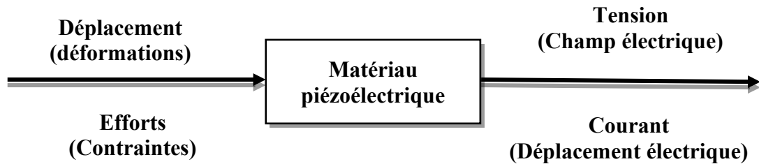
Figure I-1 : Effet direct de la piézoélectricité
