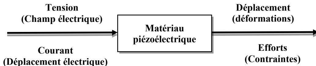
Figure I-2 : Effet inverse de la piézoélectricité
