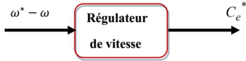
Figure II.8. Schéma fonctionnel d'un régulateur de vitesse.
