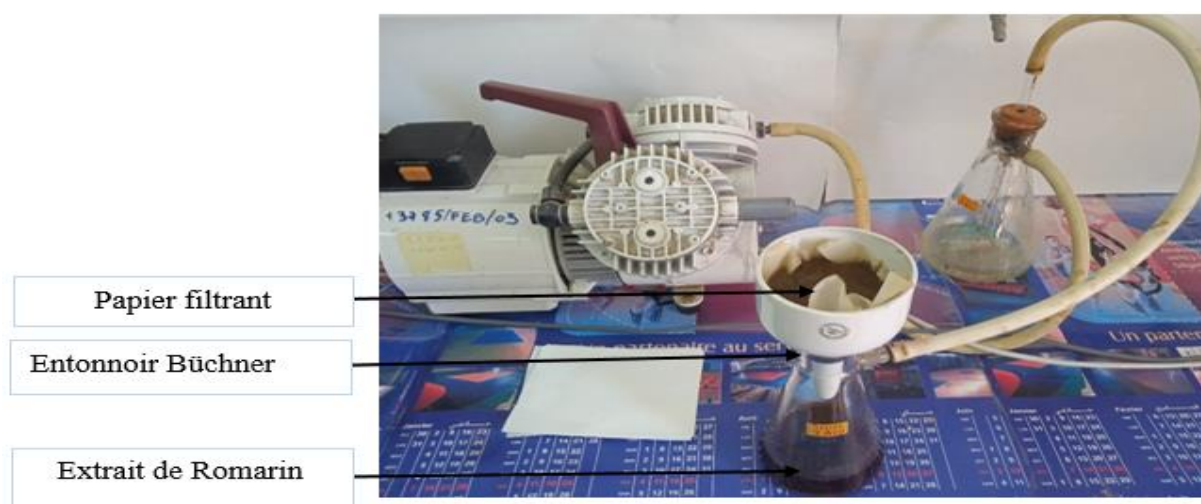
Figure II.4 : Montage de filtration sous vide
