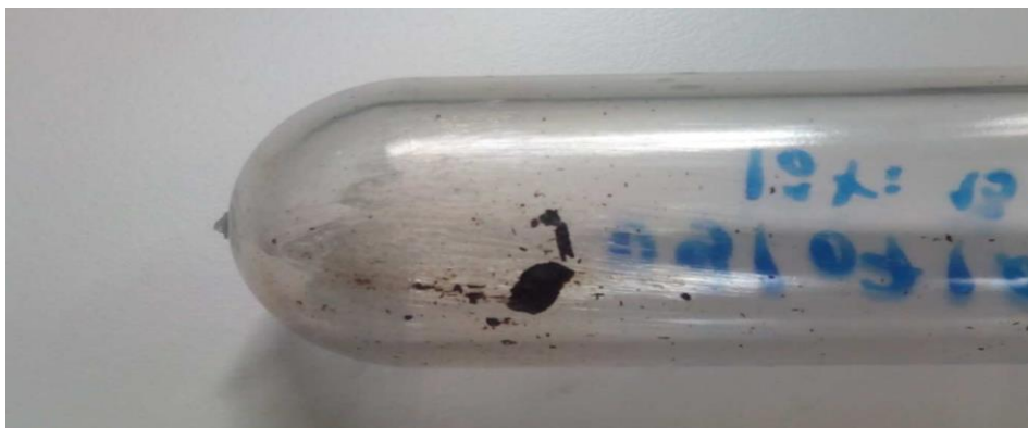
Figure I. 9 : Points noirs sur la préforme.
