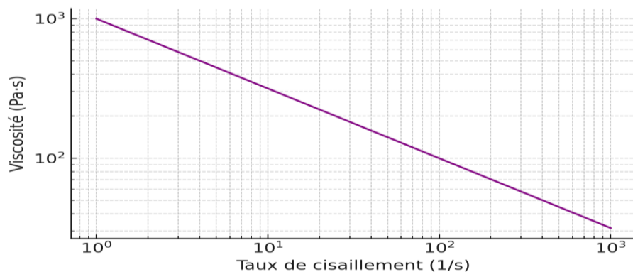
Figure I. 15 : Courbe de viscosité du PET en fonction du cisaillement [17].
