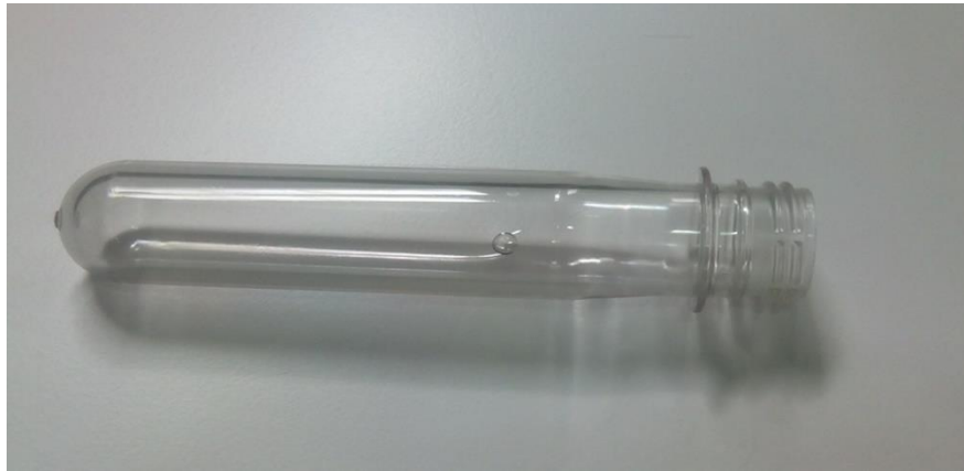
Figure I. 6 : Bulle d'air sur la préforme.
