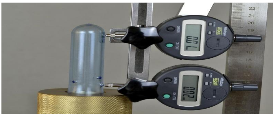
Figure II. 9 : Appareil de mesure de la perpendicularité des préformes « PPG-D ».
