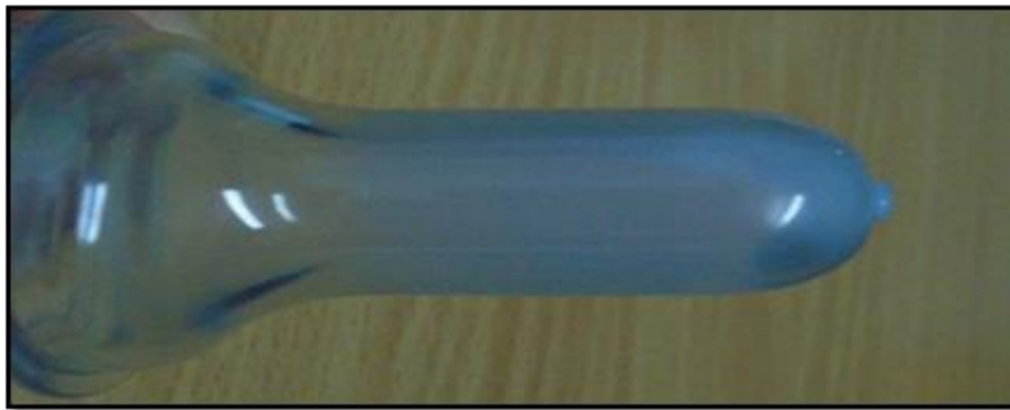
Figure I. 7 : Blanchiment sur la préforme.
