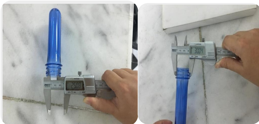
Figure II. 7 : Mesure de diamètre intérieur et extérieure de préforme par pied à coulisse.
