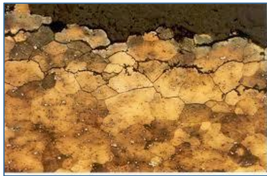
Figure I.14 : Corrosion sous contrainte (Corrosion sous contrainte, s.d.).
