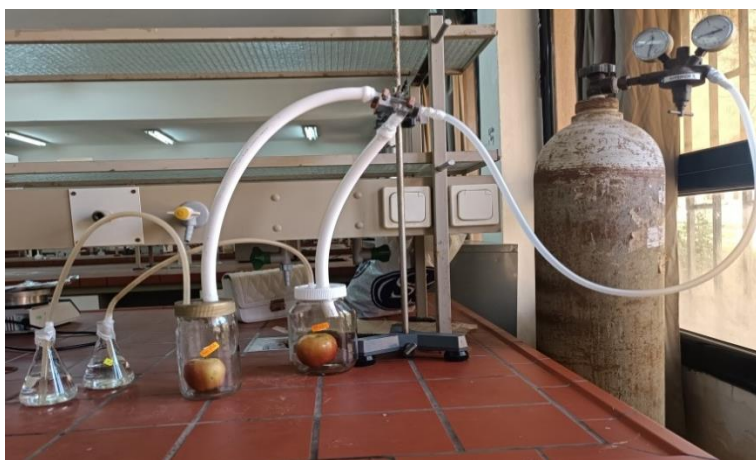
Figure 15. Montage expérimental utilisé pour mesurer la perméabilité des films au CO 2 .
