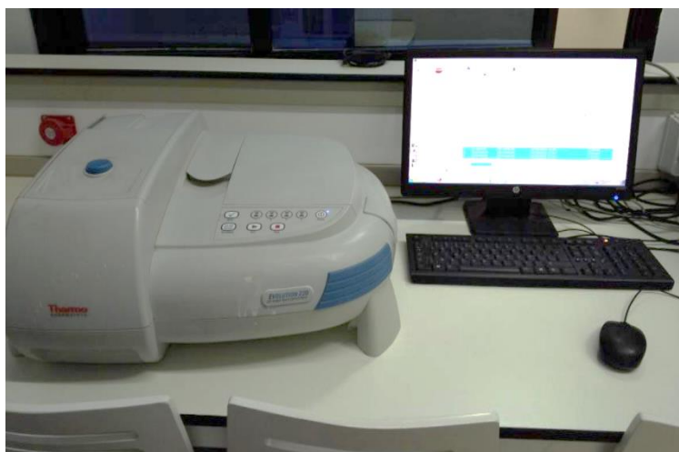
Figure III. 7: Spectrophotomètre UV-Visible utilisé pour mesurer l'absorbance.
