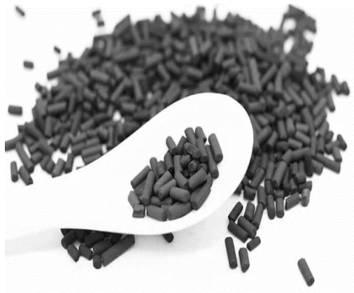
Figure I.7 : Structure de charbon actif extrudé.
