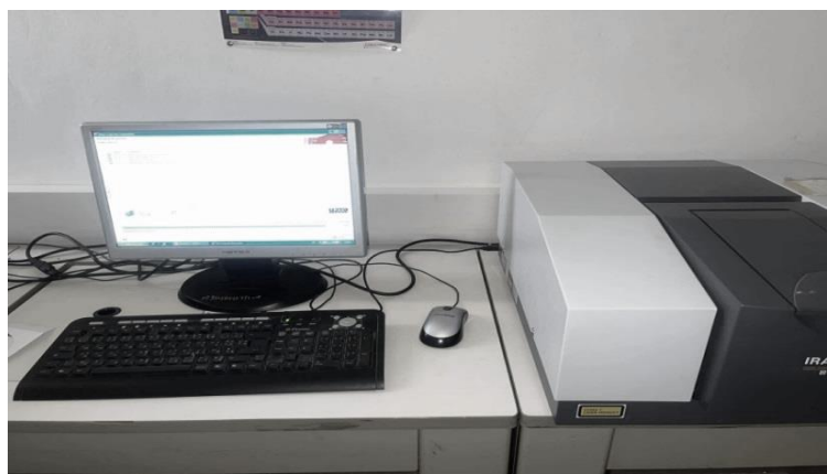
Figure III.8 : Spectrophotomètre a transformée de Fourier (IR TF) de modèle (SHIMADZU IRAFFINITY).
