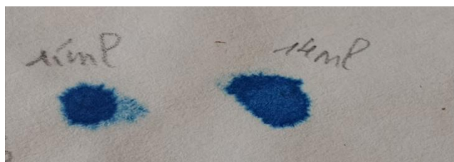
Figure V.22 : Volume de BM utilisé pour la surface spécifique de SiCMC
