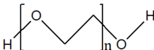
Figure IV.3 : Structure chimique du PEG [8].
