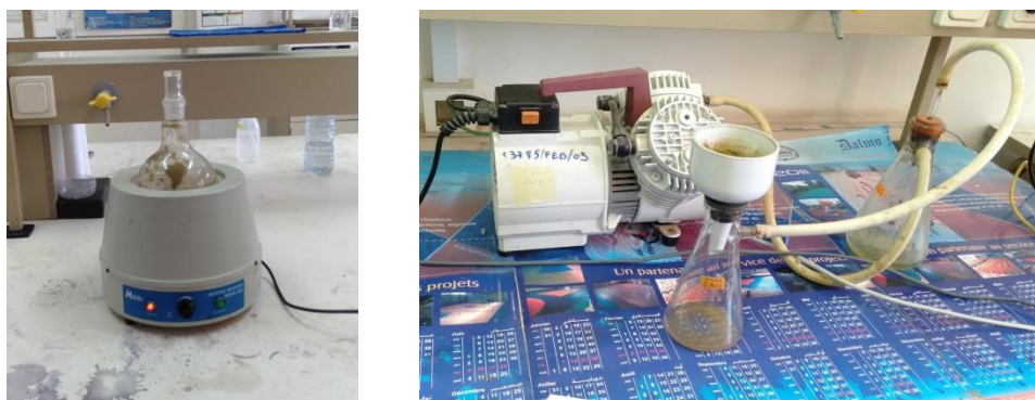
Figure II.6 : Infusion dans un ballon et filtration sous vide des extraits de plante.
