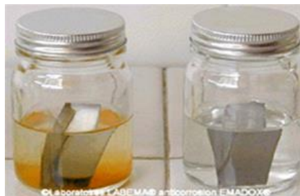
Figure I.15 : Exemple de l'état de surface d'un métal en absence et en présence d'un inhibiteur de corrosion.
