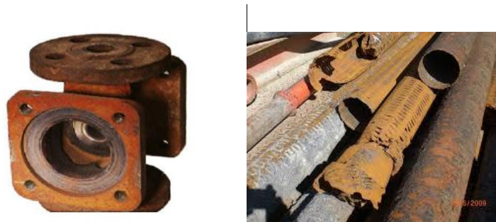
Figure I.5 : Corrosion uniforme ou généralisée
