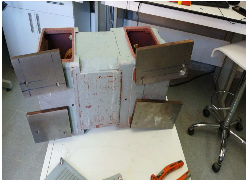
Fig. III-2 : Plaques d'acier pour réalignement des arbres
