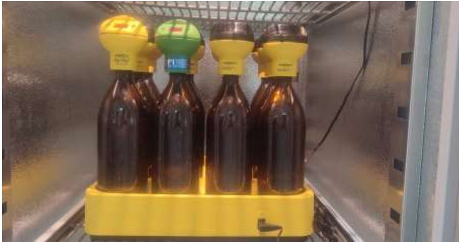
Figure 3.8: flacons ambrés dotés de manomètre et réactifs utilisés pour la mesure de la \text{DBO}_5
