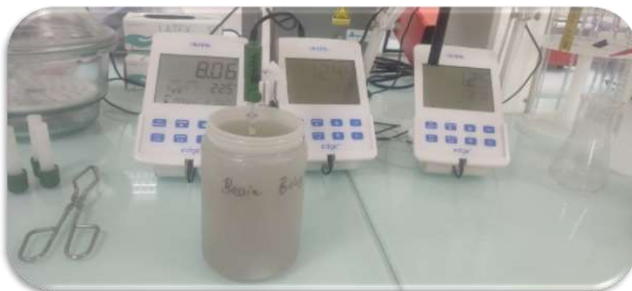
Figure 3.4 : équipement de mesure du pH, de la température, de la conductivité électrique et de l'oxygène dissout
