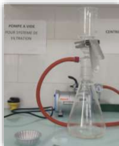
Figure 3.7: pompe à vide pour système de filtration
