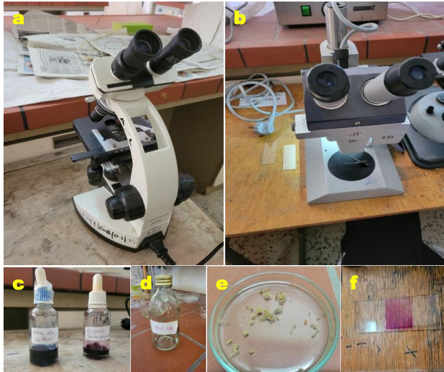
Fig. 2 : Matériel et réactifs utilisés. a : microscope optique, b : loupe binoculaire, c et d : réactifs utilisés, e : boîte de Pétri contenant les boutons floraux de différentes tailles, f : préparation pour microscopie contenant des anthères colorées à l'orcéine lactopropionique.
