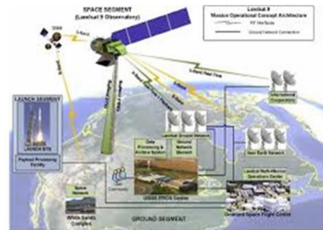
Figure 3 : Architecture du concept opérationnel de mission (Landsat-9) (USGS, 2023)
