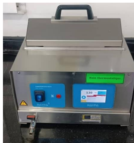
Figure 02 : Bain thermostat série WBD-5 1 .
