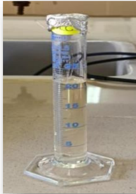
Immersion de l'échantillon de PET dans l'huile.
