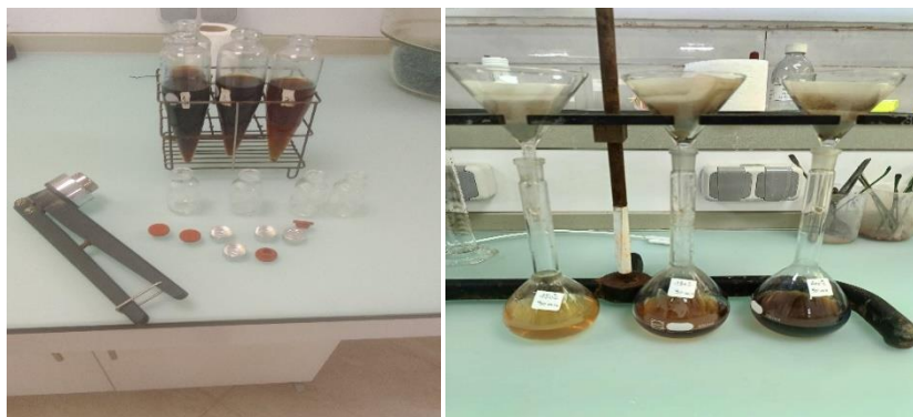
Figure II. 16: Centrifugation et filtration des échantillons
