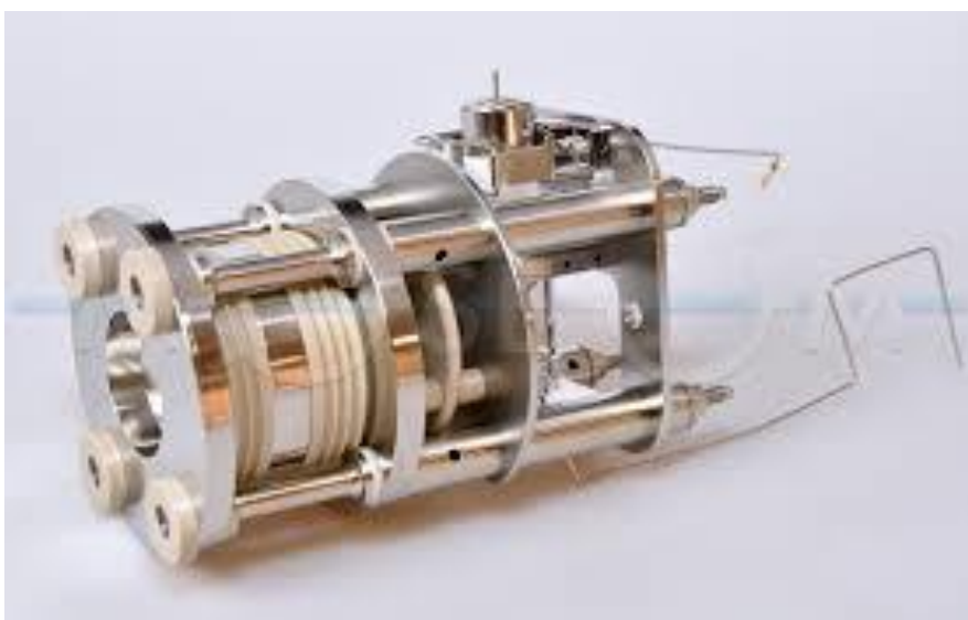
Figure II. 9: Détecteur ion trappe (analyticaltoxicology)
