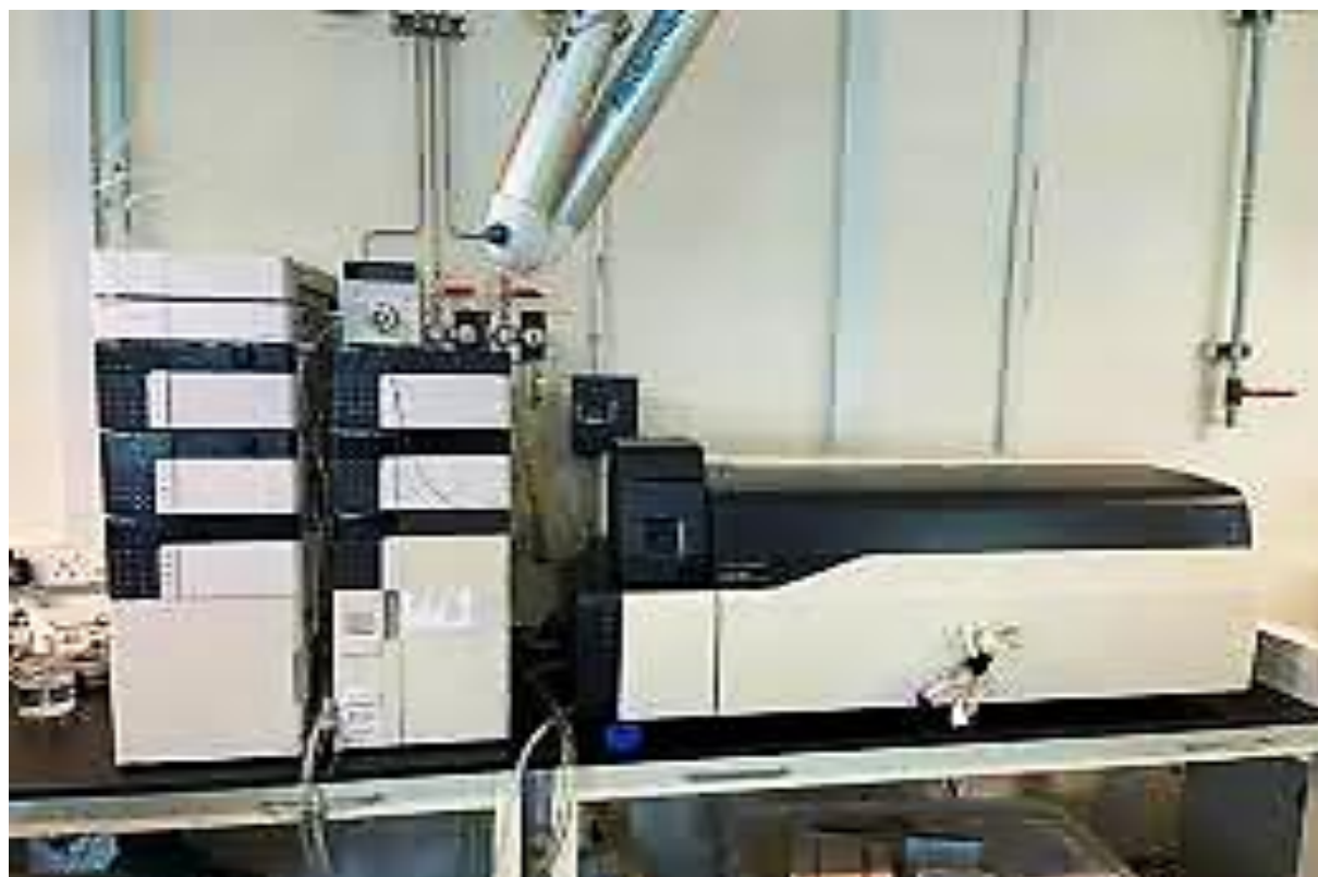
Figure II. 7: Photo d'un appareil de chromatographie liquide couplé avec un spectromètre de masse
