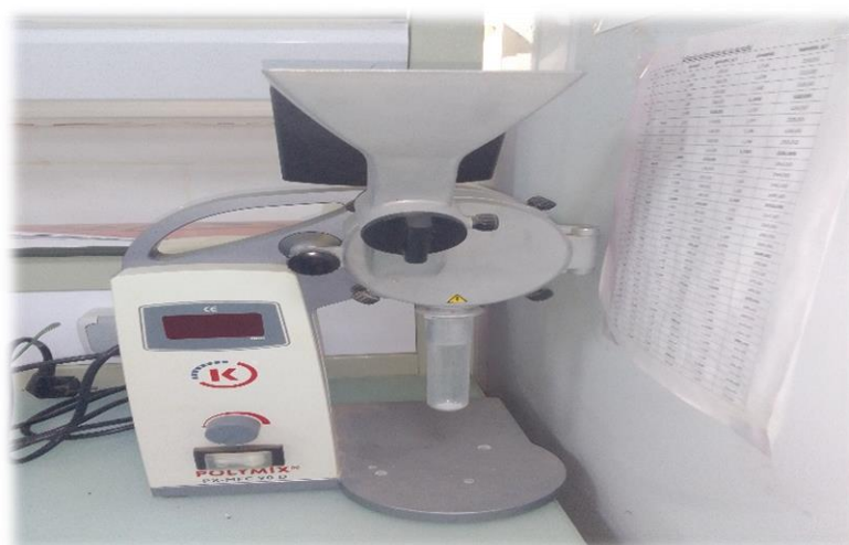
Figure II. 13: Photo d'un broyeur POLYMIX PX-MFC90 D
