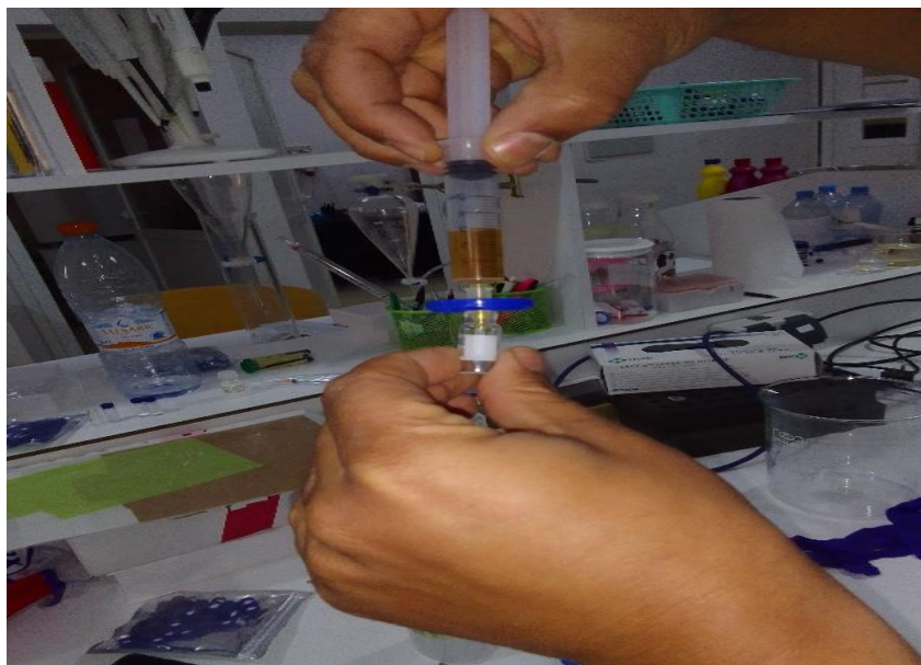
Figure II. 20: Remplissage des Vial avec seringue à filtre de 0.22 µm
