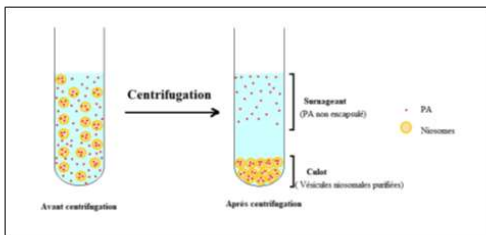
Figure 22 Schéma représentatif de la centrifugation.
