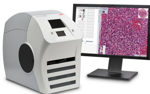
FIGURE 1.6 – Exemple de scanner (Aperio AT2) utilisé pour la numérisation de lames. [9]
