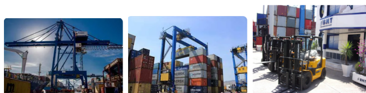
(a) PORTIQUES DE QUAI SUR GERBEUR RAIL (QC) (b) PORTIQUES SUR ELEVATEURS PNEUS (RTG) (c) CHARIOTS
