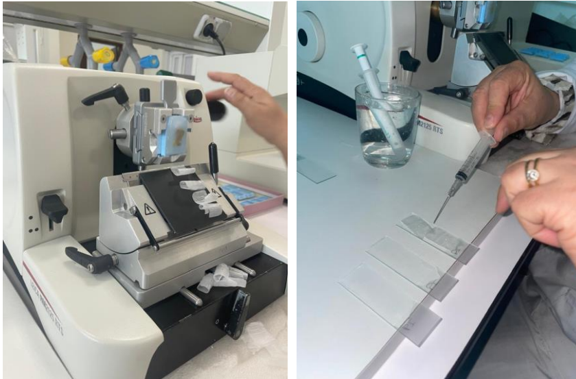
Figure 29 : microtomisation et le collage des coupes (photo personnelle).
