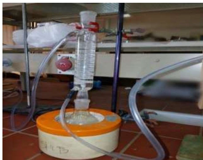
Figure 13 : Photographie du montage de l'appareillage du dosage du carbone (Anne modifiée)
