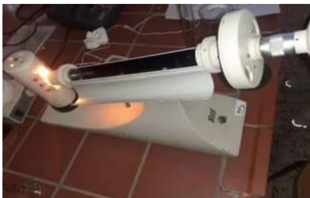
Figure 9 : Photographie du polarimètre de Laurent
