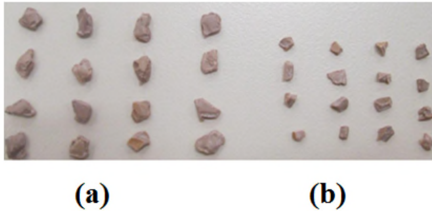
Figure III.4 : Représentation photographique des deux classes de l'ABS utilisé (a) ABS 2-5mm, (b) ABS 1-2mm
