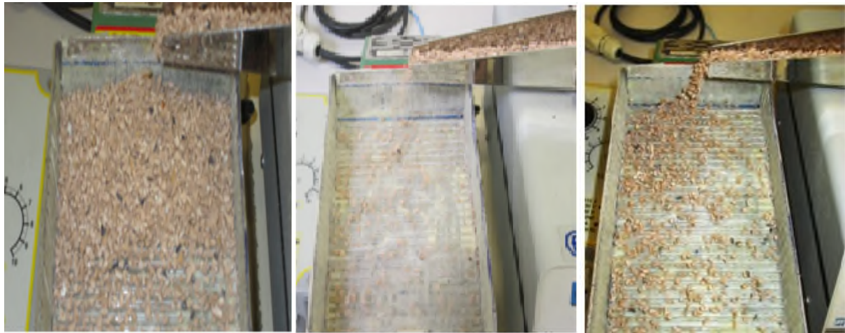
a) \Phi = 3.84\text{g/s} V = 6.84\text{cm/s} b) \Phi = 2.85\text{g/s} V = 11.30\text{cm/s} c) \Phi = 6.66\text{g/s} V = 12.93\text{cm/s}
