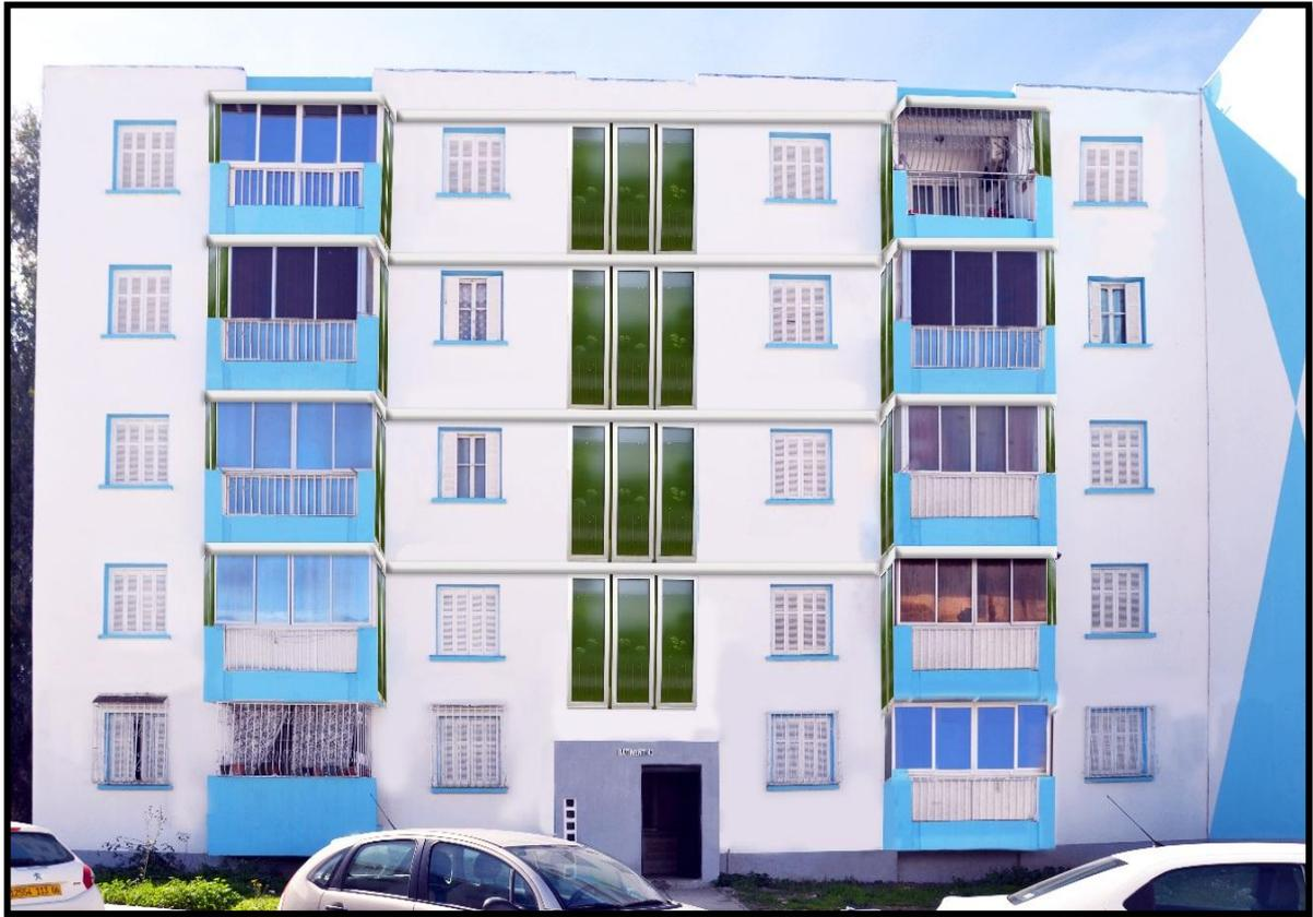
Figure 44 : l'intégration des panneaux photo bioréacteur sur la façade EST ; scénario 2, (auteur).
