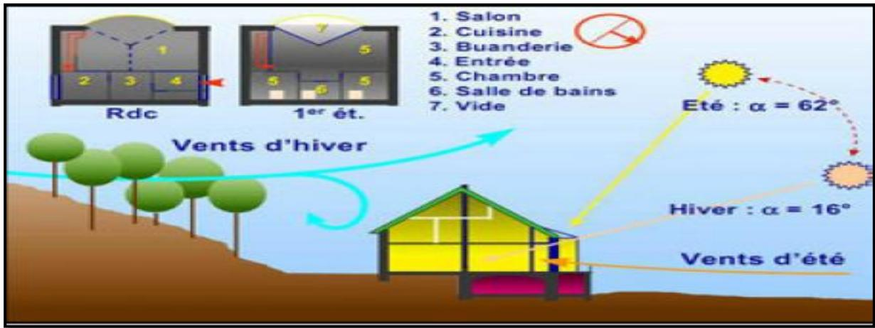
Figure 6 : les principes d'architecture bioclimatique ([http://www.jan-maison-passive.com/c bioclimatique](http://www.jan-maison-passive.com/c_bioclimatique) .20 décembre 2016)
