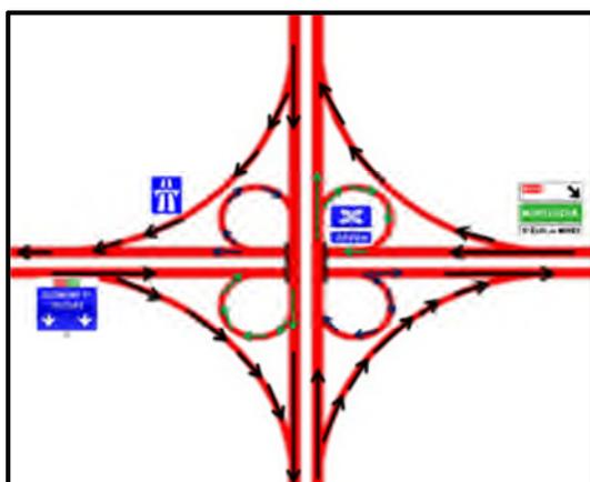
Figure 13 : Echangeur autoroutier.
