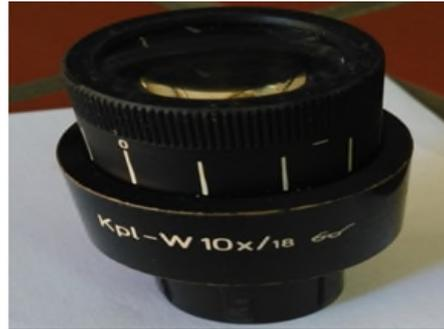
Figure 13: photo originale d'un oculaire gradué
