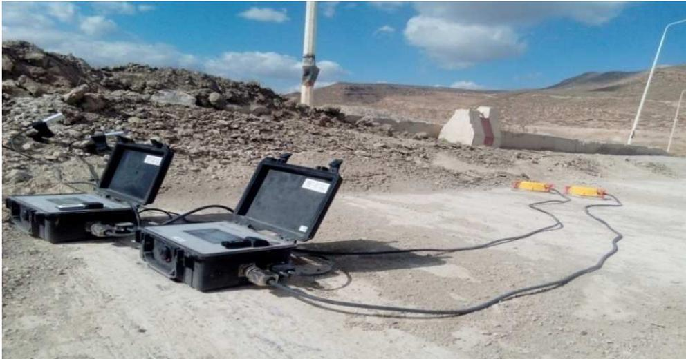
**Fig III-9.** Photo d'enregistreur des vibrations (sismographe), (au niveau de la carrière de Chouf Amar).
