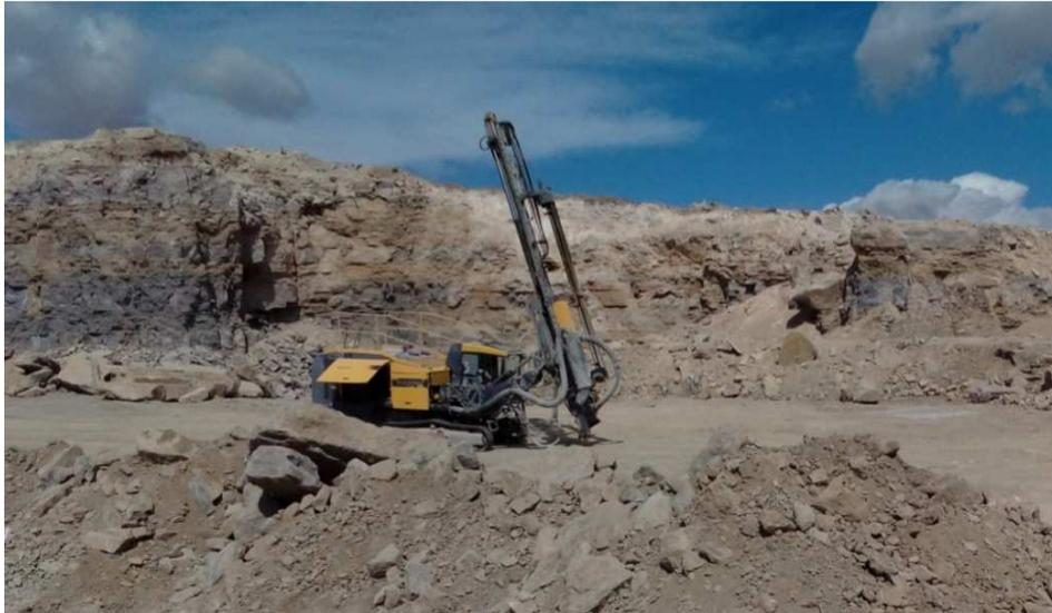
**Fig I-9.** Foration d'un trou de mine au niveau de la carrière de Chouf Amar.
