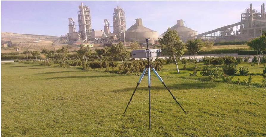
**Fig IV-2.** Aéroscope portable de la poussière [18].
