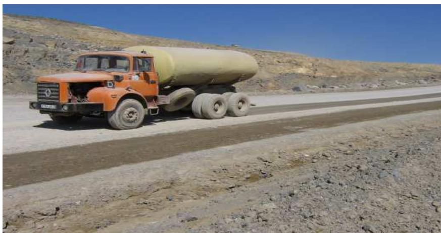
**Fig IV-1.** Arrosage des pistes (Photo au niveau de la carrière de Chouf Amar).
