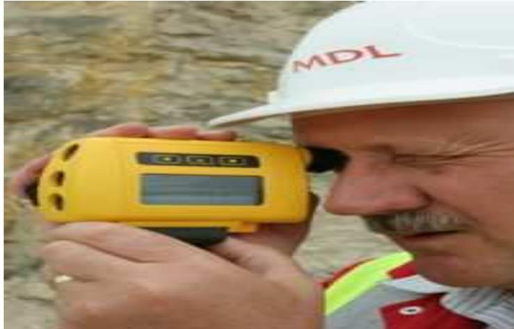
**Fig III-2.** Mesure des paramètres des fronts de taille à l'aide Laser-Ace, mesure instantanée des épaisseurs à abattre (banquette) [15].
