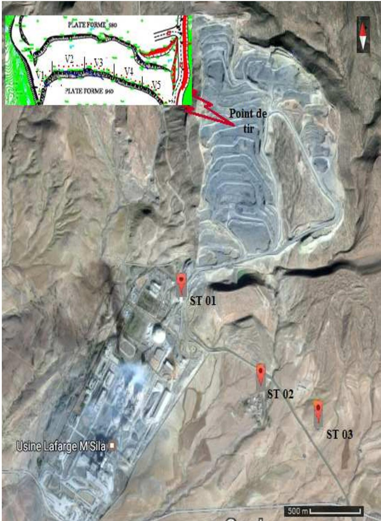
Fig III-12. L'emplacement des sismographes (Image de Google Earth).
