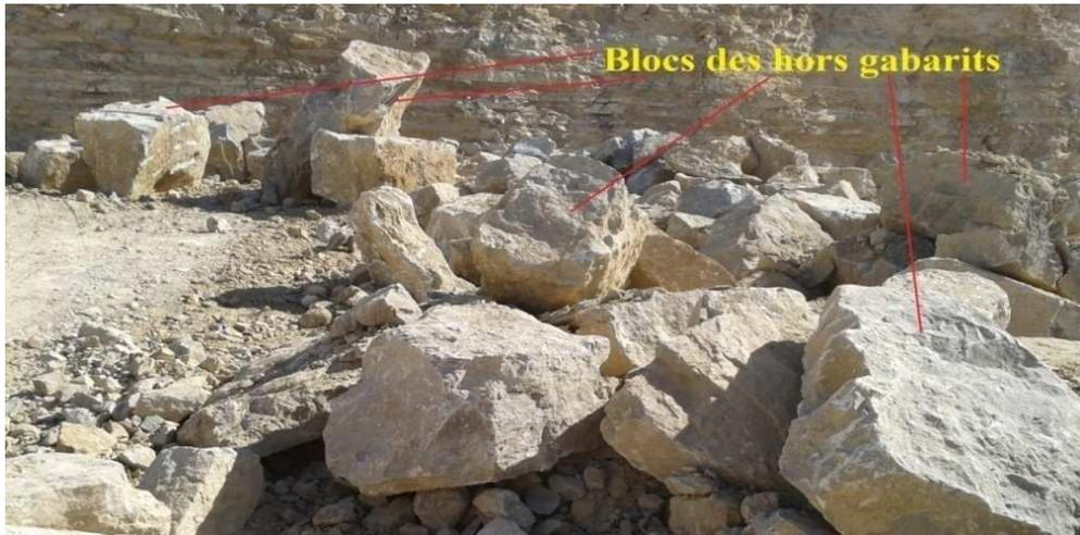
Fig III-3. Représentation des roches hors gabarit (au niveau de la carrière de Chouf Amar).
