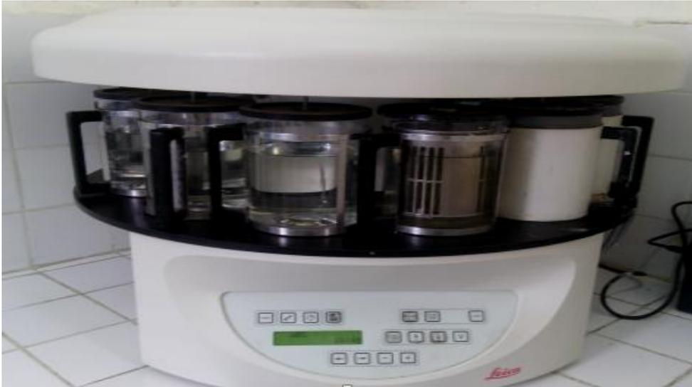
**Figure 5 :** Appareil de déshydratation (Original).
