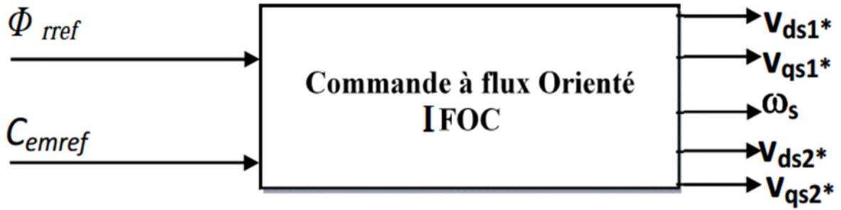
Fig. III.3. Bloc de commande à flux Orienté.
