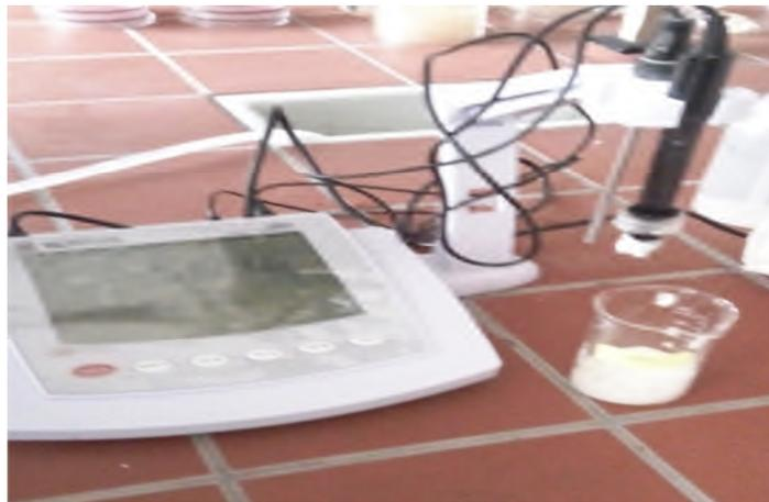
**Figure N°11:** Appareil de PH mètres
