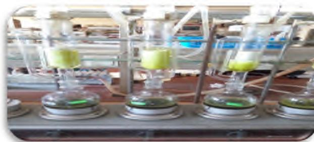
**Figure N°14** : Photographie d'Appareil de Soxhlet
