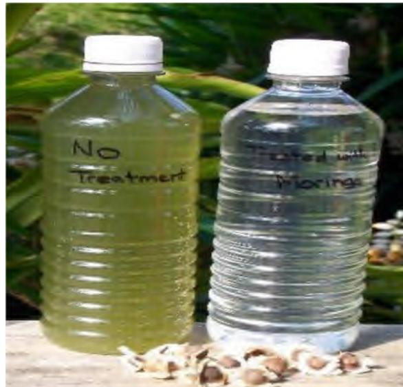
**Figure N°05 :** Eau d'étang non traitée (bouteille de gauche) et traitée avec des graines de *Moringa* (Fahey, 2005)
