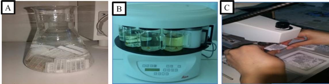
**Figure 13 :** Photographies représentatives des étapes de fixation, déshydratation et enrobage. *A : Fixation au formol, B : Automate de déshydratation, C : enrobage à la paraffine (photographie originale.)*
