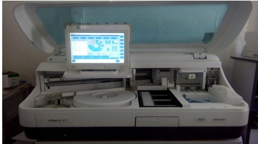
**Figure 12 :** Photographie originale d'automate de COBAS e 411, utilisé dans le dosage sérologique du HCMV (*photographie originale*).
