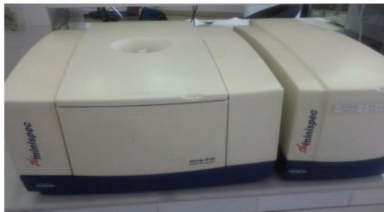
**Figure 03 : Spectromètre à Résonance magnétique nucléaire (RMN)**
