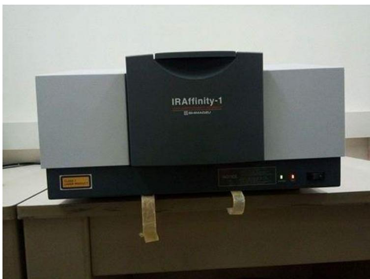
**Figure II.5 :** Spectrophotomètre infrarouge à Transformée de Fourier (IRAffinity-1).
