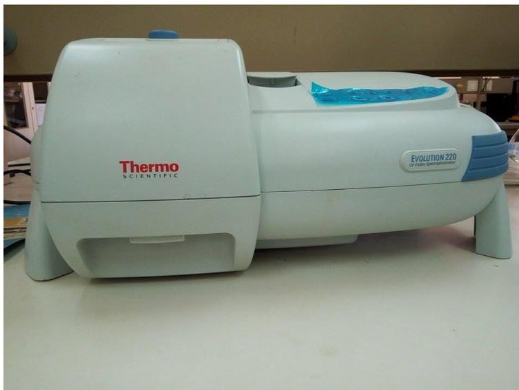
**Figure II.6 :** Spectromètre d'absorption UV-Visible (Thermo scientific Evolution 220).
