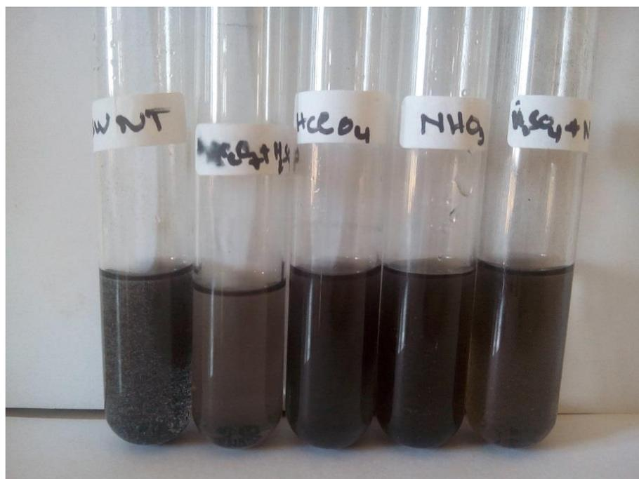
**Figure III.10 :** Nanotubes de carbone dispersés dans du DMF après 30 min de sonication.
